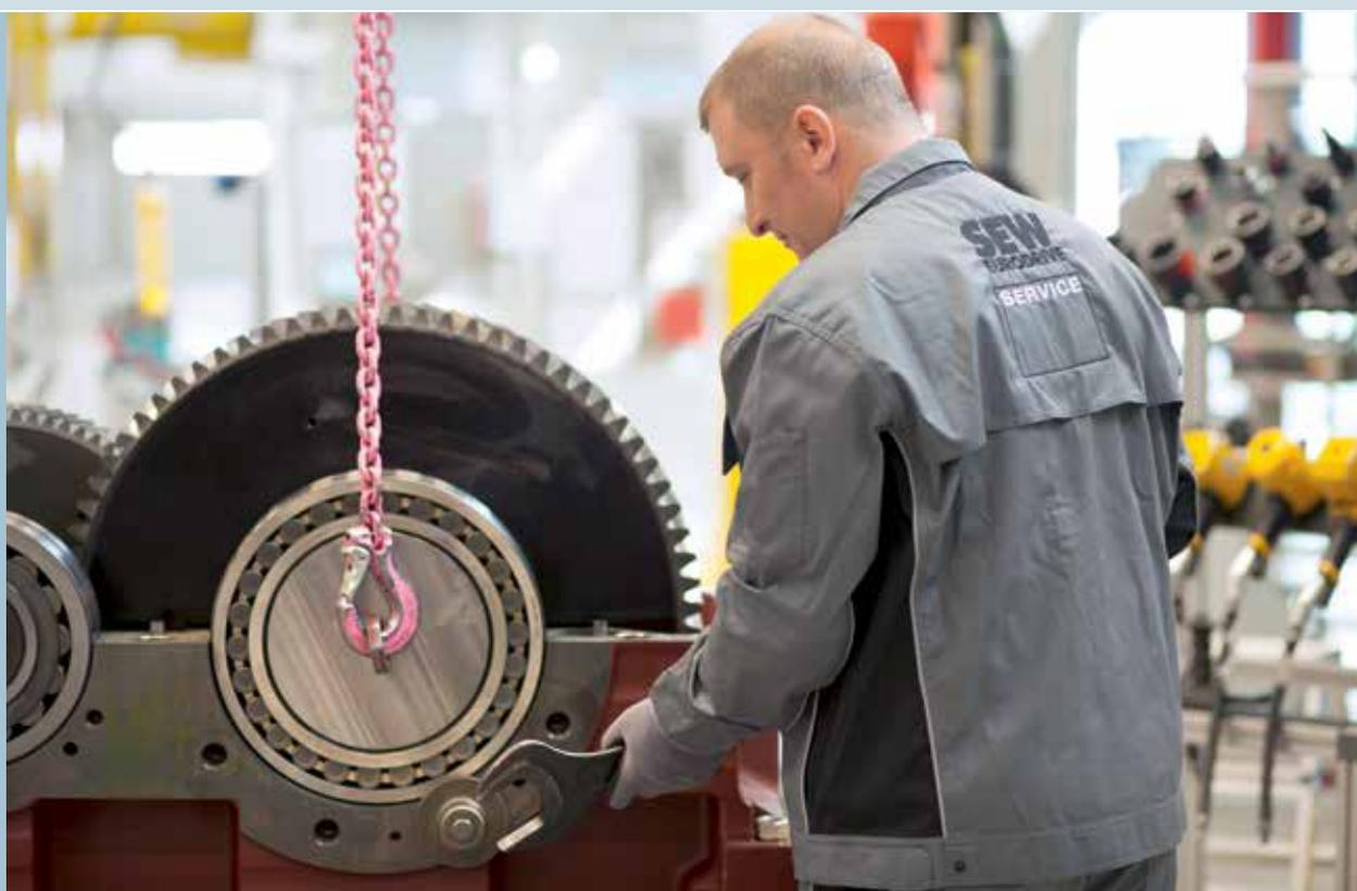
Post-procesamiento de orificios de rodamientos en reductores con casquillos
