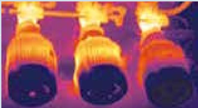
El motor central muestra una temperatura excesiva
