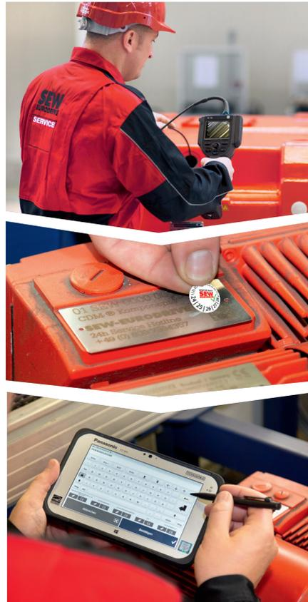
Flexible Video-Endoskopie zur Getriebe-diagnose
