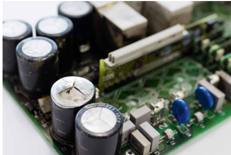
Explosionsvermeidung der Kondensatoren durch Formierung
