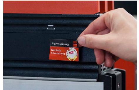
Kennzeichnung der überprüften Frequenzrichter
