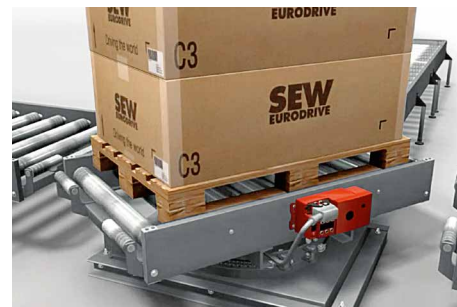
Fördertechnik mit Richtungswechsel Drehtisch, Fahrwagen
