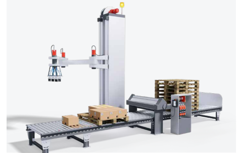
Portalpalettierer und Palettierroboter mit einfacher oder komplexer Kinematik
