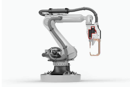
Schweißzangen z. B. in der Automobilindustrie
