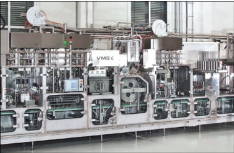
Aseptische Abfüllanlagen Für höchste Anforderungen an die Reinigung und Desinfektion
