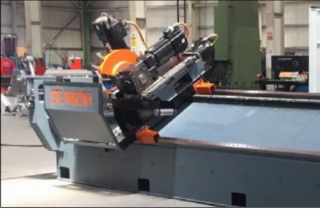
Fliegende Bearbeitung Schneiden von sich bewegendem Endlosmaterial auf eine definierte Länge.
