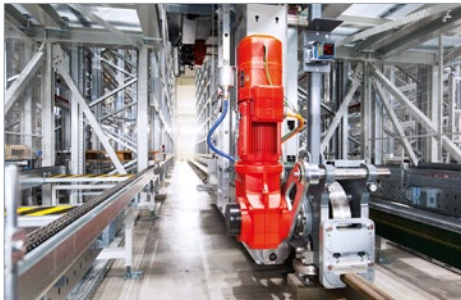
Intralogistik Fahrwerks- und Hubantrieb als positionsgeführter dynamischer Bremsmotor mit spielarmem Kegelradgetriebe
