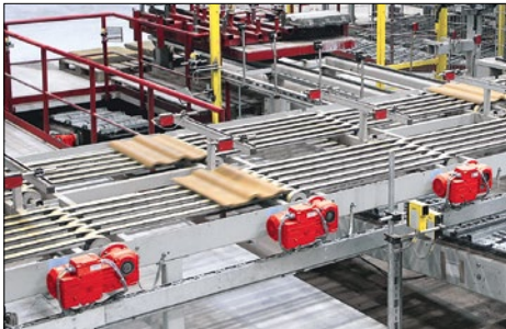
Nur-Umrichterbetrieb (S9) Motoren im ausschließlichen Betrieb am Umrichter – Bewegungen mit unterschiedlichen Geschwindigkeiten: Transportieren, Be- und Entschleunigen
