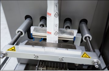
Verpacken Das Werkzeug siegelt und schneidet einen Verpackungsschlauch zu Einzelprodukten.
