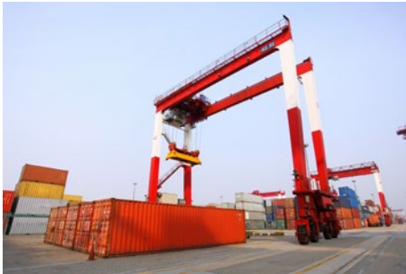
Brückenkran Durch Kaskadierung der Softwaremodule kann sowohl der Drehmomentausgleich an jeder Kranseite wie auch die Schrägstellung beider Seiten ausgeglichen werden.
