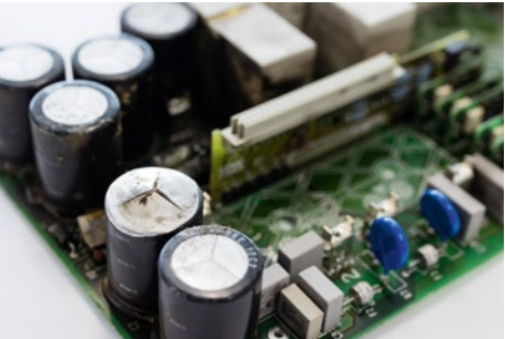
Explosionsvermeidung der Kondensatoren durch Formierung
