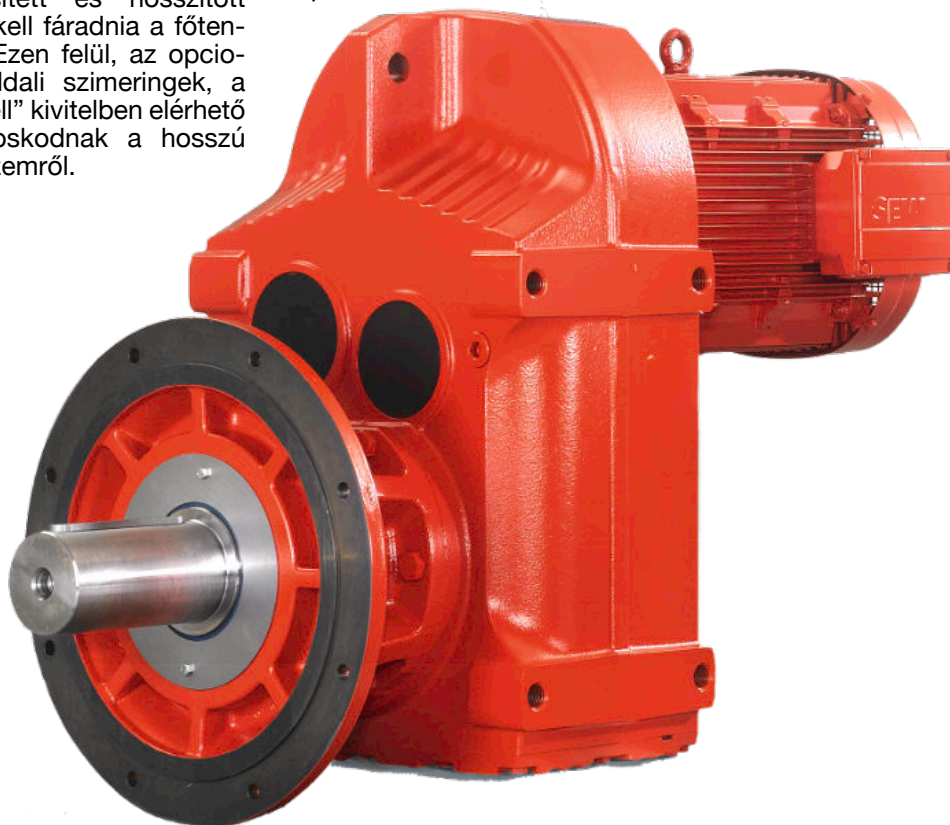
107-es méretű laposkeres, tömörtengelyes kivitelű hajtómű, 7,5kW-os IE3 energiahatékonysági osztályú DRN aszinkron motorral szerelve (FM107DRN132M4)
