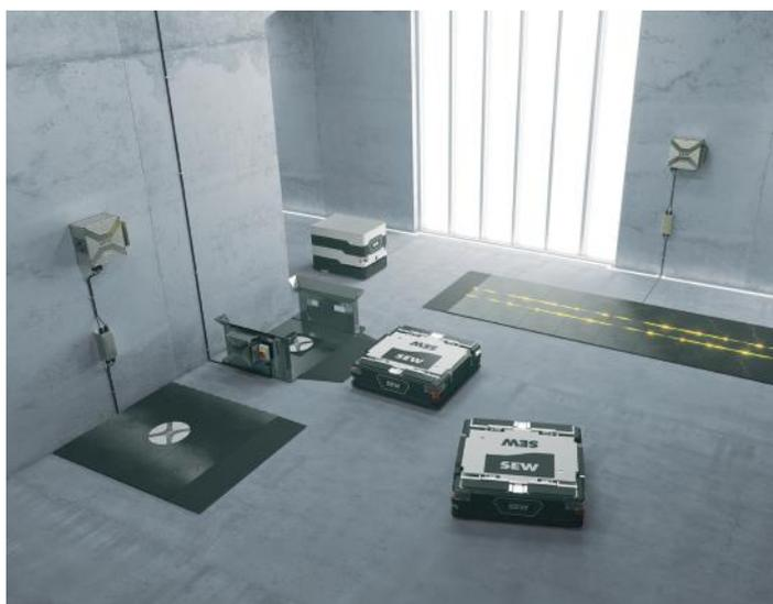
**MOVITRANS®** è il **sistema di trasferimento dell'energia senza contatto** con alimentatore decentralizzato in campo, in grado di garantirvi:
