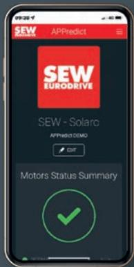
La web app APPredict rappresenta una soluzione completa per monitorare lo stato di salute del motoriduttore. Grazie all'installazione semplice e veloce di **sensori wireless** direttamente sui riduttori (SEW che di terze parti) è possibile ottenere una gestione della durata effettiva dell'olio, della temperatura di lavoro e dei dati vibrazionali (ISO 10816-1).
