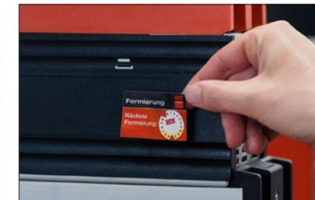
Kennzeichnung der überprüften Frequenzumrichter
