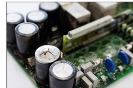
Explosionsvermeidung der Kondensatoren durch Formierung
