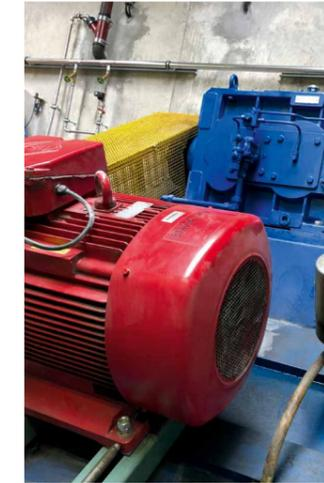
**Links (vorher):** Kegelstirnradgetriebe (Fremdantrieb) mit Riemenantrieb
