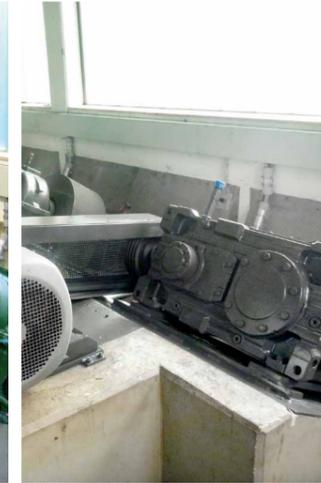
**Rechts (nachher):** Kegelstirnradgetriebe der aktuellen Baureihe mit Riemenantrieb
