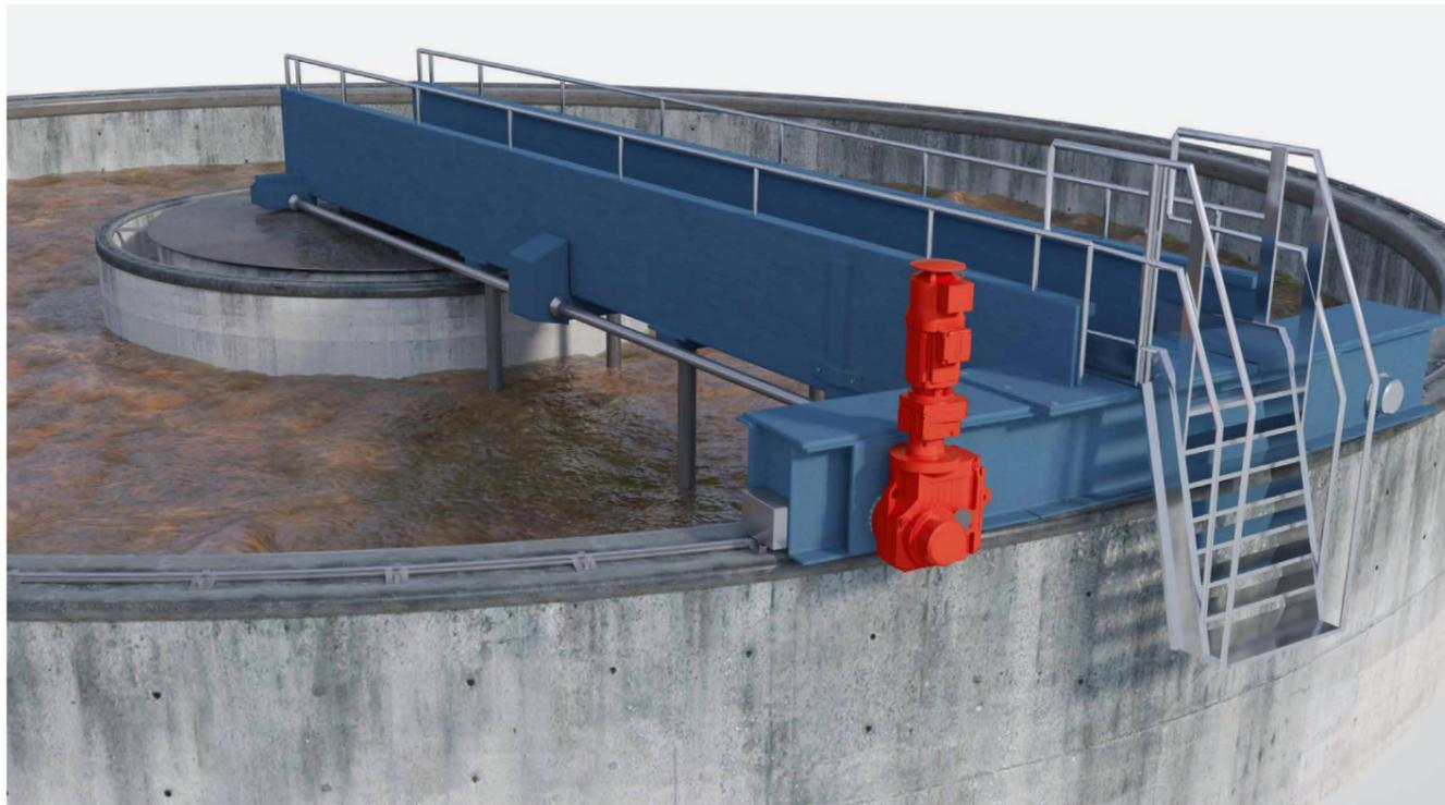
Ein Schlammeindicker wird verwendet, um den Wassergehalt im Klärschlamm zu reduzieren und somit das Volumen des Schlammes zu verringern. Dies führt zu einer dichteren Konsistenz des Schlammes, was die nachfolgende Behandlung erleichtert. Für die niedrige Fahrgeschwin-
