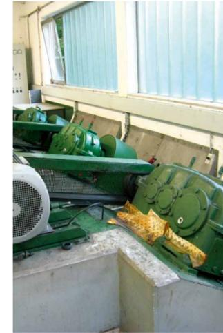
**Links (vorher):** Kegelstirnradgetriebe (Fremdantrieb) mit Riemenantrieb
