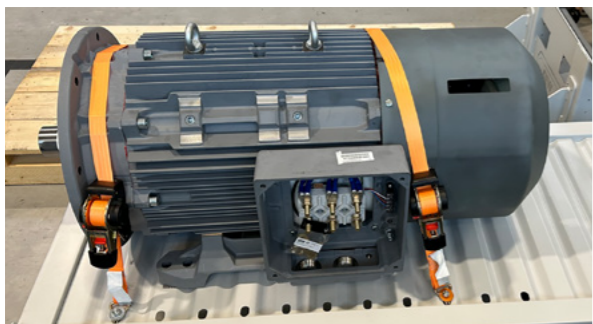
Stahlflachpalette für innerbetrieblichen Transport
