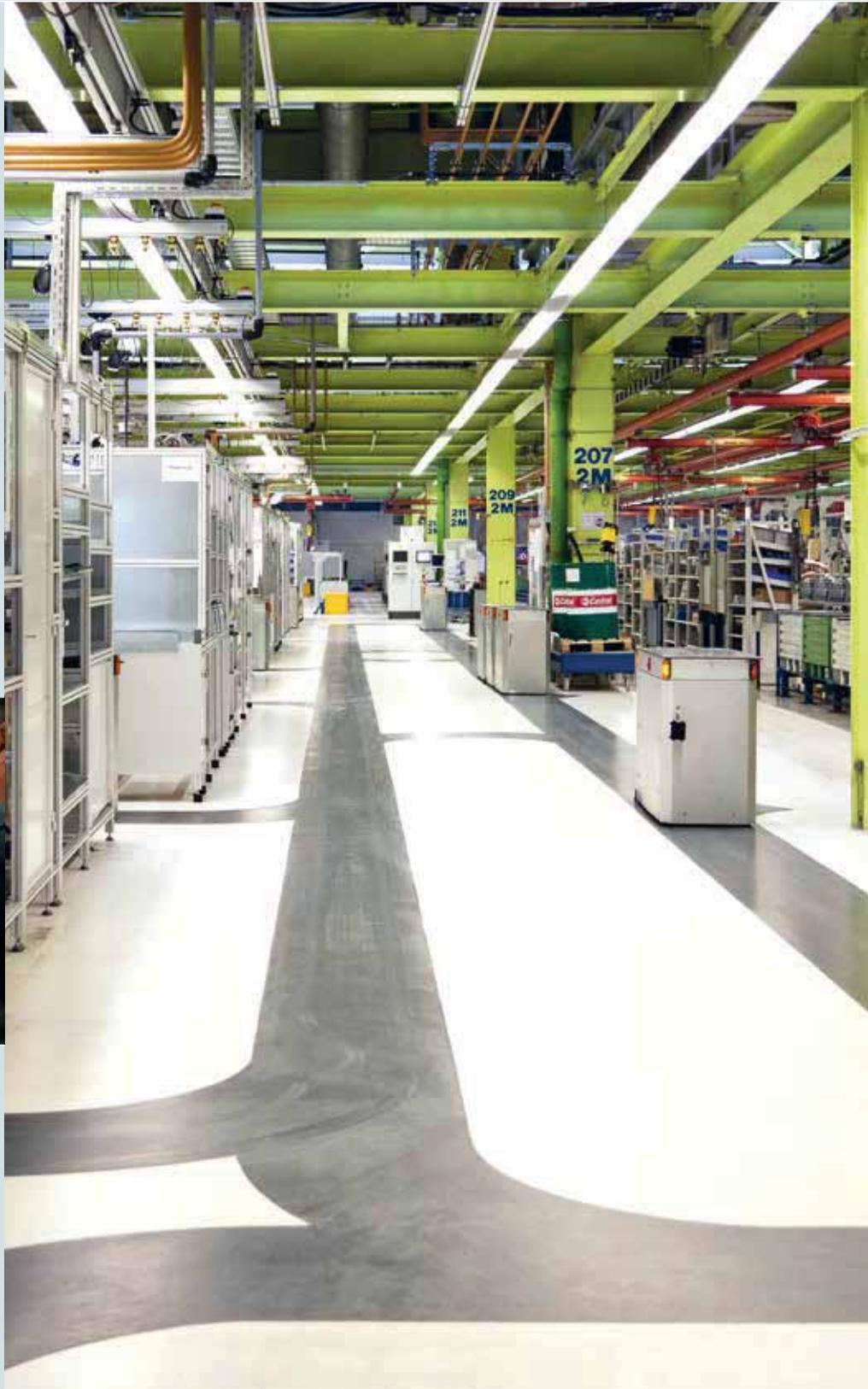
MOVITRANS® besteht aus stationären und mobilen Komponenten zur kontaktlosen Energieversorgung beweglicher elektrischer Verbraucher. Die benötigte Energie wird dabei über elektromagnetische Felder (kontaktlos) von einer Spule oder isolierten stationären Leitern über einen Luftspalt auf die mobilen Verbraucher (Fahrzeuge) punktuell oder auch entlang einer Strecke übertragen. Gegenüber der klassischen Energie-
