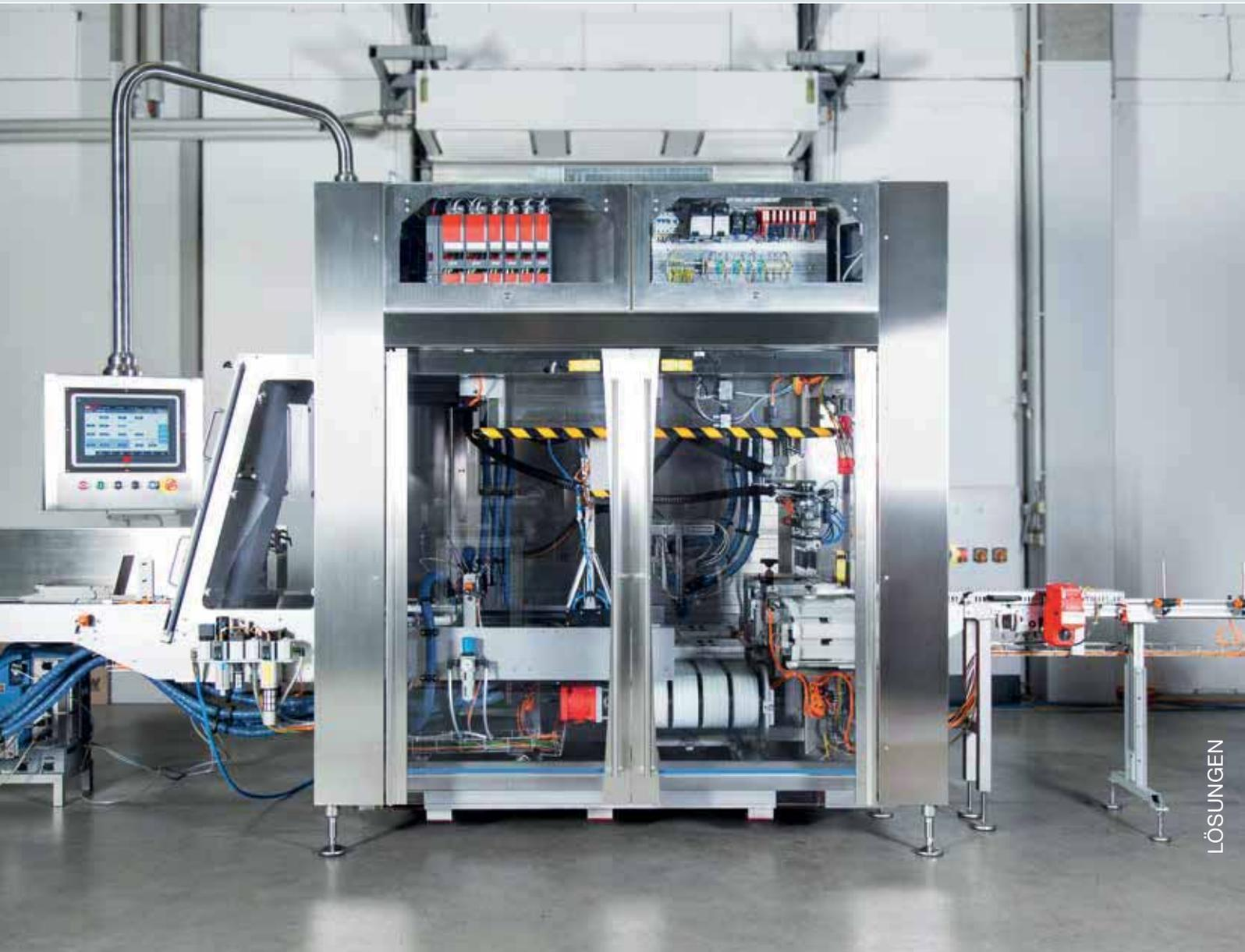
Kartoniermaschine mit Fördertechnik
