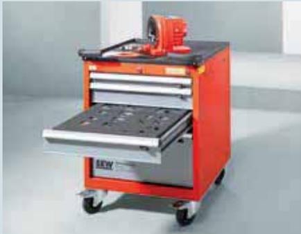
**Demoschrank Stirnradgetriebe R57FAD2**
