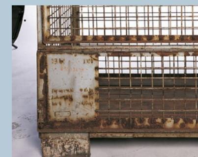
1. Der Steilwinkelaufsatz oder die Ecksäulen sind verformt.
