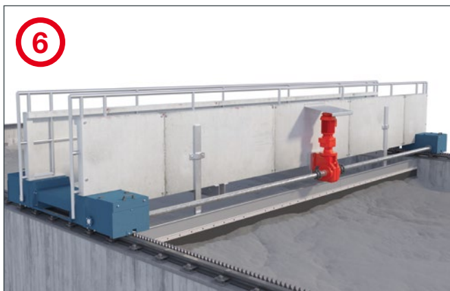
Vorklärung mit Räumer Unser Lösungsbeispiel: Kegelradgetriebe K... als Fußausführung mit durchgehender Hohlwelle und Stirnrad-Getriebemotor R..DR.. als Vorschaltgetriebe für große Übersetzungen.
