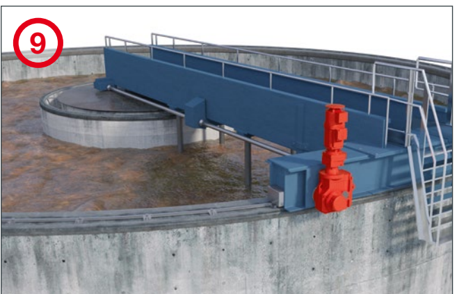
Schlammeindicker Unser Lösungsbeispiel: Kegelradgetriebe K... mit Drehmomentstütze und Stirnrad-Getriebemotor R..DR.. als Vorschaltgetriebe für große Übersetzungen.
