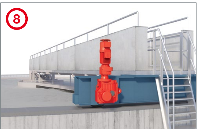
Nachklärung mit Räumer Unser Lösungsbeispiel: Kegelradgetriebe K... mit Drehmomentstütze und Stirnrad-Getriebemotor R..DR.. als Vorschaltgetriebe für große Übersetzungen.
