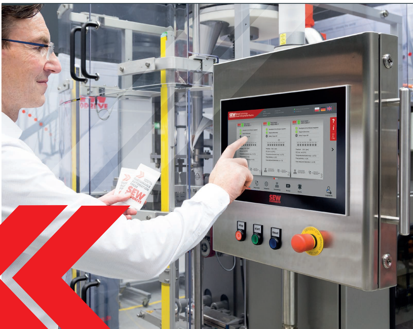
Rys. 8. Panel Utrzymania Ruchu w wersji Basic z panelem OPT11D-150-0
