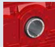
Полый вал со шпоночным пазом (или со шлицами)
